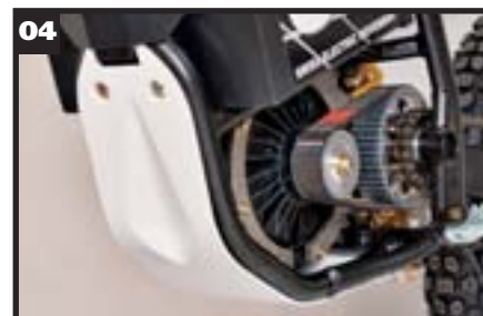
[1] La instrumentación es bastante completa y en lo que en una moto tradicional sería el depósito, está el indicador de carga de batería. [2] La moto se enchufa a un generador o a la corriente fácilmente. [3] El amortiguador está situado casi en vertical y lleva bieletas. [4] La transmisión primaria es por cinta, no por cadena. La situación del motor es la misma que en una moto de gasolina. [5] La batería es voluminosa. [6] Horquillas Marzocchi, regulables. [7] Detalle del alimentador externo de las baterías, que funciona a través de un generador de gasolina.
