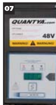
[1] La instrumentación es bastante completa y en lo que en una moto tradicional sería el depósito, está el indicador de carga de batería. [2] La moto se enchufa a un generador o a la corriente fácilmente. [3] El amortiguador está situado casi en vertical y lleva bieletas. [4] La transmisión primaria es por cinta, no por cadena. La situación del motor es la misma que en una moto de gasolina. [5] La batería es voluminosa. [6] Horquillas Marzocchi, regulables. [7] Detalle del alimentador externo de las baterías, que funciona a través de un generador de gasolina.
